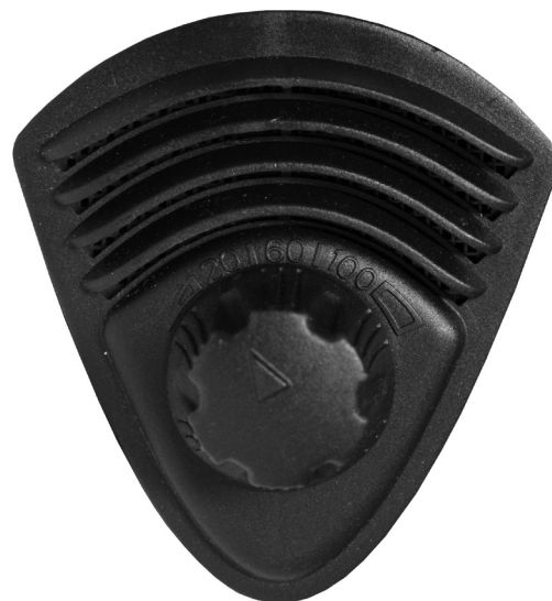
Bild 1: Inställning av luftinloppsventilen: pil till höger = som minst
